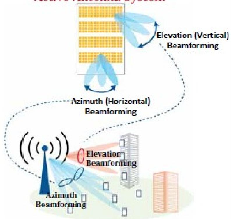
Diagrammi di irraggiamento dinamici che consentono di ottimizzare la copertura della Stazione Radio Base
